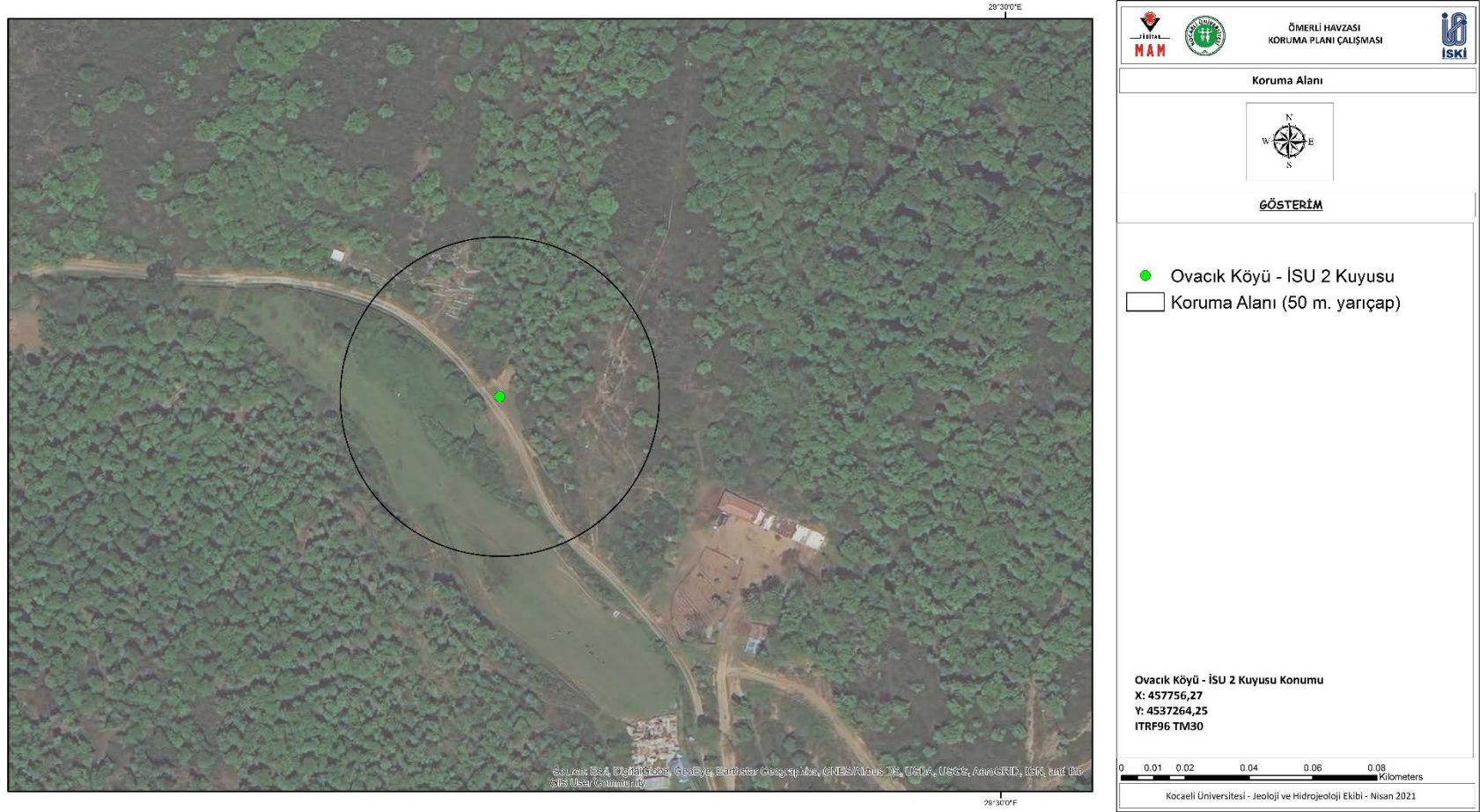
Şekil 2. Ovacık İçme Suyu Kuyusu Mutlak Koruma Alanı
